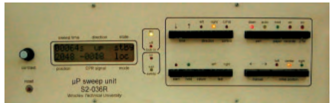
Fig. 5. Front view of the digital field sweeper Rys. 5. Widok cyfrowego układu przemiatań od przodu
